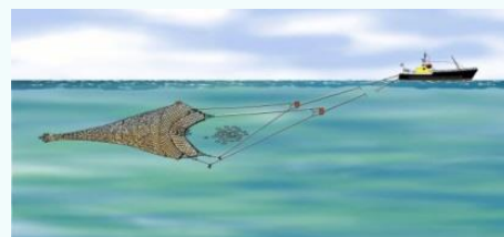
Figure 24 : Chalut pélagique (Source : Ifremer).
