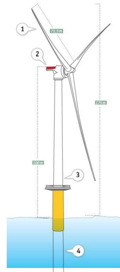
**Figure 10 - Schéma de l'éolienne Haliade 150 retenue pour le projet de Courseulles-sur-Mer (Alstom) 1 : Pale ; 2 : nacelle, contenant la génératrice de courant ; 3 mâts ; 4 : fondation monopieu**
